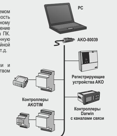
До 126 устройств при длине до 1200 м. При установке более 32 устройств необходимо использовать трансляционные усилители **AKO-80024**.
